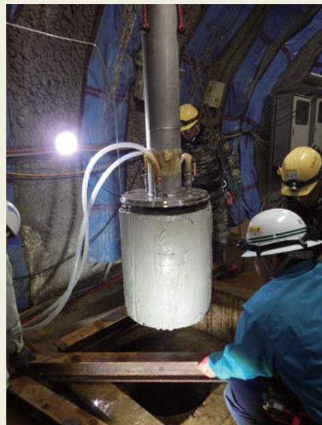
緩衝材再冠水試験後の供試体引き上げ
