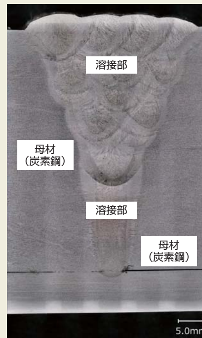
廃棄体容器試験体の溶接断面
