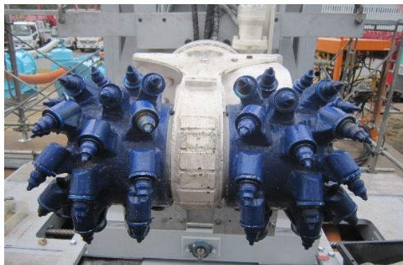
図 4 高飽和度の隙間充填材切削時の油圧切削機のヘッドの閉塞（飽和度 90%）
