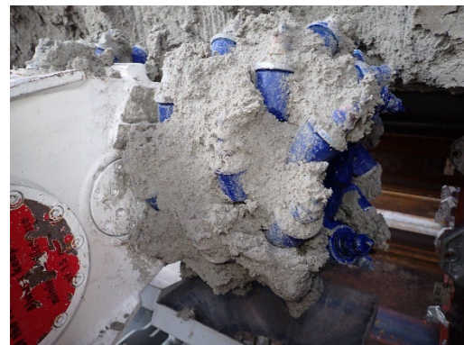
図 4 高飽和度の隙間充填材切削時の油圧切削機のヘッドの閉塞（飽和度 90%）
