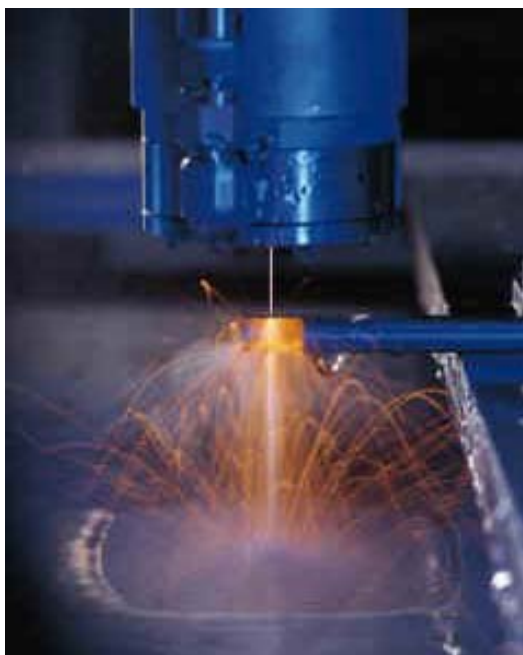
図 7-1 レーザー・ウォータージェットハイブリッド加工
