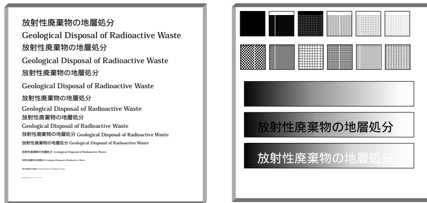
図 7-3 高精度のドット加工刻印試験の成果イメージ
