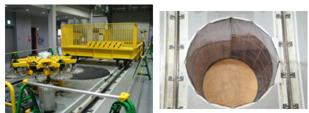
緩衝材定置試験設備
