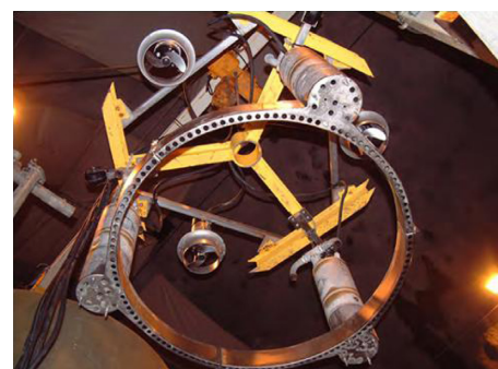
図4 緩衝材スラリー化装置
