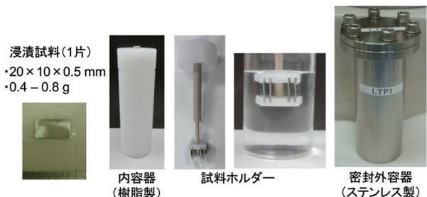
図-26 浸漬試料、試料ホルダーと試験容器
