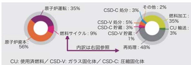
図-16 分離変換無しの場合の発電容量 60GWe の高速中性子炉の発電電力量 kWh 当たりの平準化コストの構成（核変換無し、割引率：最初の 30 年間は 4%、その後は 2%）<sup>26)</sup>
