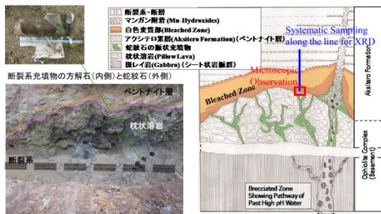
図-8 Saile鉱山のトレンチの断面写真 (左) と模式断面図 (右)
