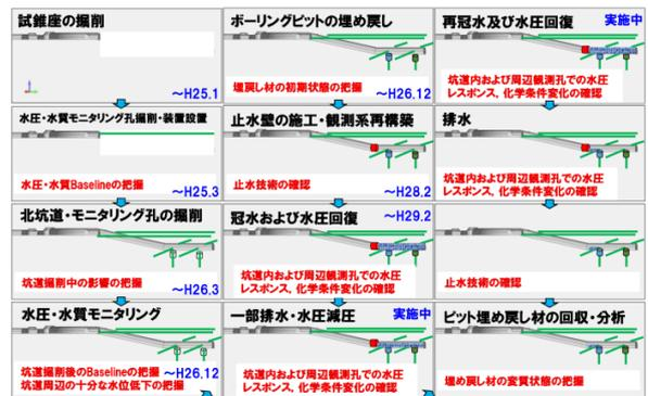
図-21 再冠水試験の流れ
