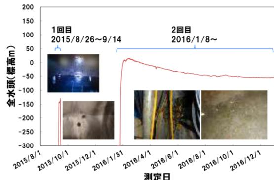
図-22 冠水坑道内の水圧の変化
