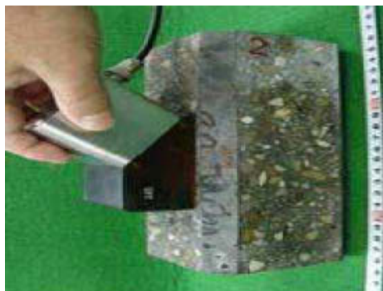
写真-7 コンクリートへの非破壊検査技術の適用
