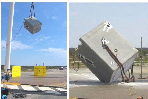
写真-5 実物大廃棄体容器の落下試験
