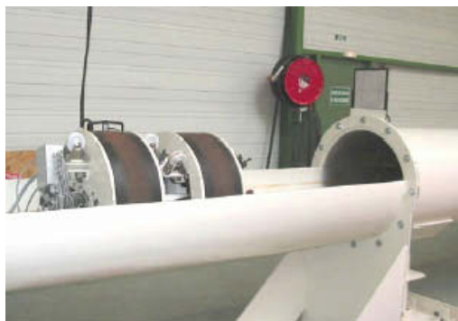
写真-6 ガラス固化体用定置ロボットの外観
