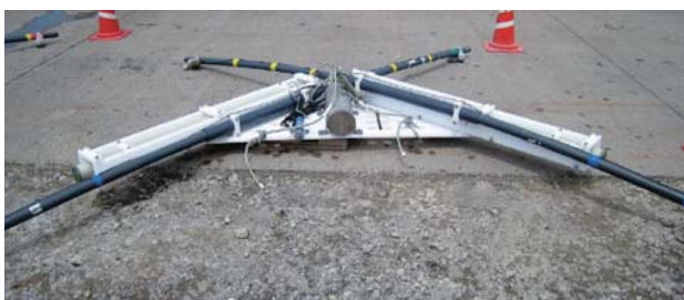
図-5 電磁探査用カイト型海底センサー (Ueda et al. 2014 8) より)
