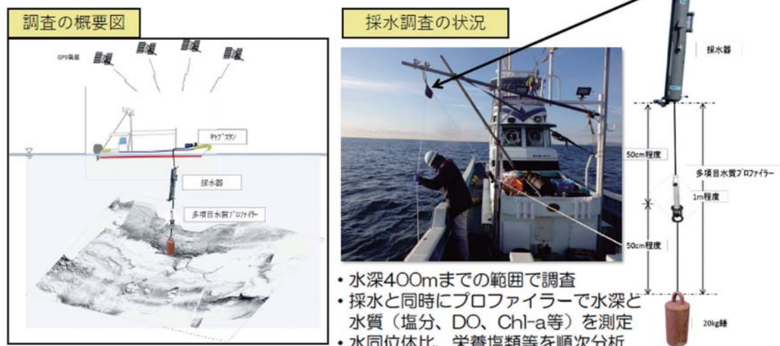
図-11 海底湧出地下水調査の様子（沿岸部処分システム確証技術開発、2020 12) より）
