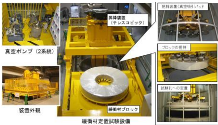
図 3 実規模緩衝材ブロック真空把持実証試験装置の製作例 (原理センターより提供)
