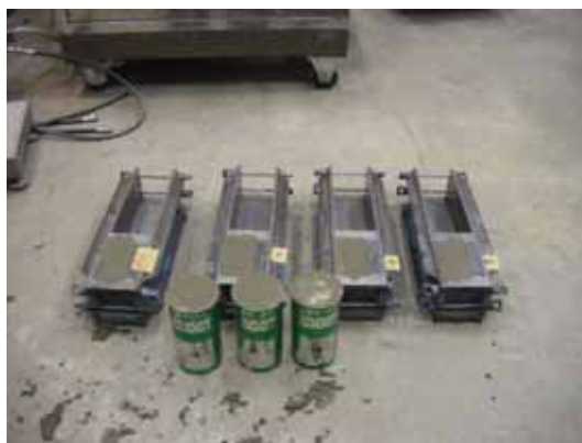
図 4.4-3 モルタル被覆試験体の作製状況
