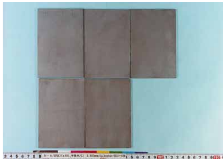
脱スケール後
