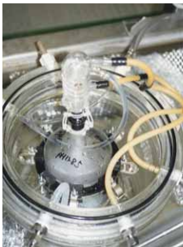
図 3.2-7 試験容器の模式図及び試験容器の内部の様子
