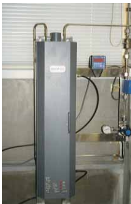
図 3.2-5 ガス精製装置（超高純度精製装置）
