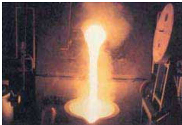
高周波誘導溶融炉からの出湯
