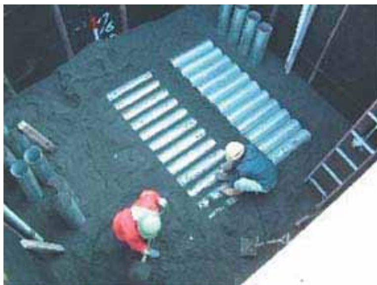
雑固体廃棄物の埋設・埋戻し試験
