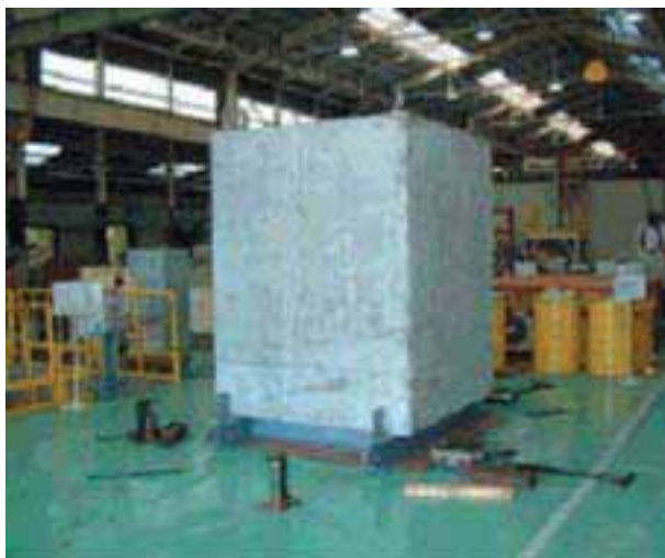
高強度高緻密コンクリート容器のモックアップ
