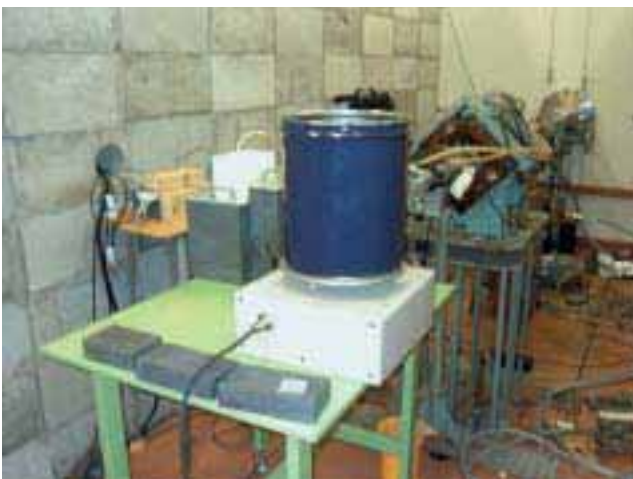
光中性子法によるウラン濃度測定装置
