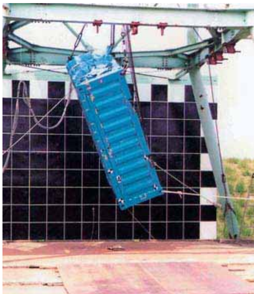
模擬充填固化体8本を収納した輸送容器の落下試験
