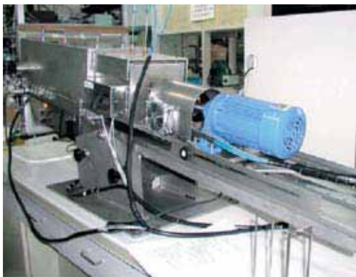
フッ素化除染装置（ロータリーキルン）の外観
