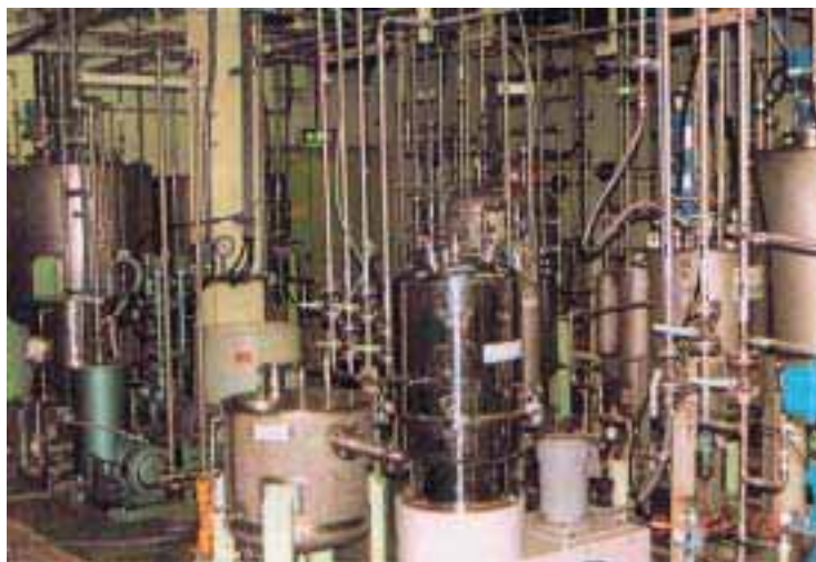
スラッジ類廃棄物からのウラン除染・回収装置
