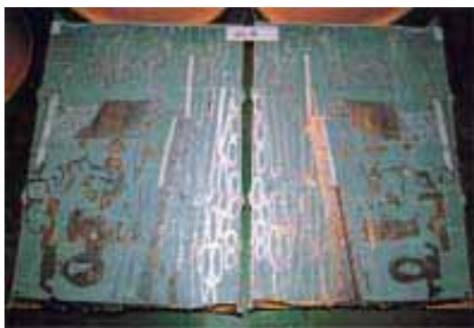
雑固体充填固化体の断面（模擬廃棄物）
