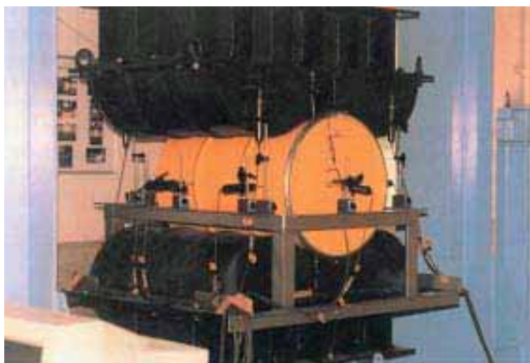
模擬充填固化体埋設時の最大荷重を想定した荷重試験
