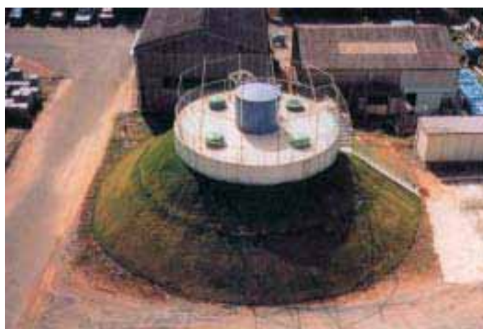
地下水の浸透を抑制する機能を持つコンクリート製モデルサイロの止水性能評価試験
