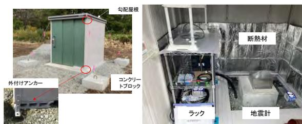
図-4 地震計④の設置状況
