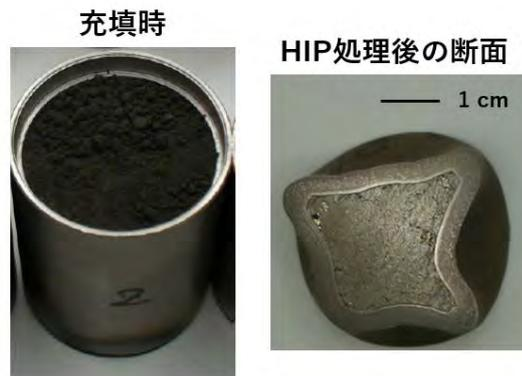
図-3 HIP法による酸化膜の閉じ込め技術(金属ZrへのZrO<sub>2</sub>の固定及び酸素固溶)
