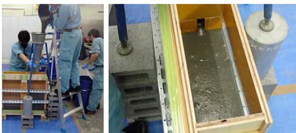
図-14 充填性試験の実施状況
