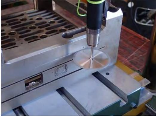
図-2 新規PWRノズル(モックアップ材)を用いた浸漬試験片の切り出し方法の検討
