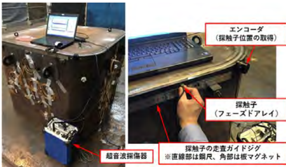
図-5 超音波探傷試験の状況
