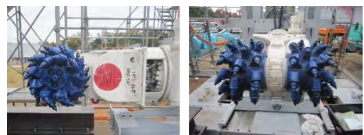
図-6 切削部（ツインカッター、軟岩掘削用）
