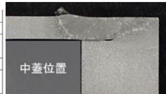
図-4 ノンフィラー TIG 溶接: 溶接条件(左)と断面マクロ(右)
