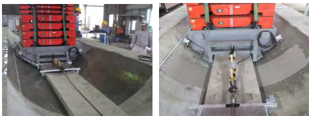
図-10 充填材除去後の環境を想定した要素試験の様子 (左：散水した走行面、右：ベントナイトペースト)
