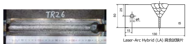
図-13 溶接部の腐食に関する浸漬試験用試験片 (左図:試験片を採取した溶接後の LA 溶接試験体、右図:試験片の寸法)
