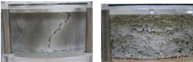
(a)NaCl 溶液通水時 (b)MgCl<sub>2</sub>溶液通水時
