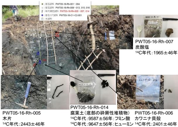
図-3 Narra 地区トレンチ 5 の <sup>14</sup>C 年代測定結果
