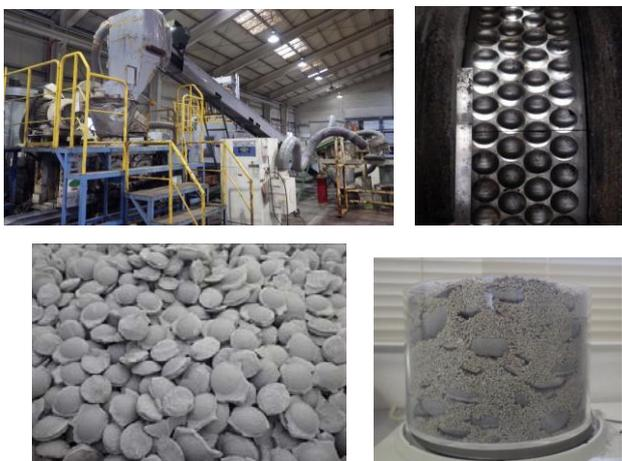
図-12 ブリケッティングによるペレット製造試験
