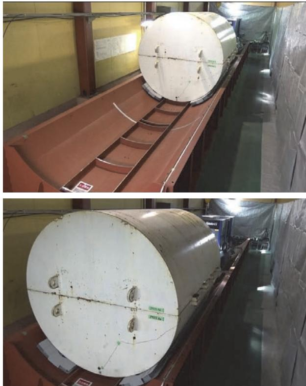
図-7 搬送・定置装置 動作確認の様子
