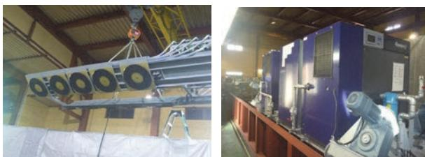
図-6 製作した定置装置 (左) と搬送装置 (右)
