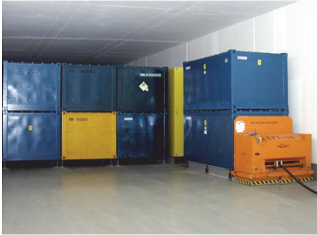
図-1 ドイツ、コンラッド処分場で使用される角型容器
