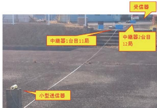
図-3 中継の多段化に関する機能確認試験の様子（屋外での通信試験）
