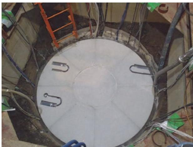
図-4 人工バリア性能確認試験における模擬処分孔中の緩衝材ブロックへの小型地中無線送信装置の設置状況（左下：土圧計、左上及び右上：間隙水圧計）
