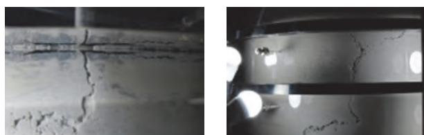
図-9 工学規模試験における水みち形成状況
