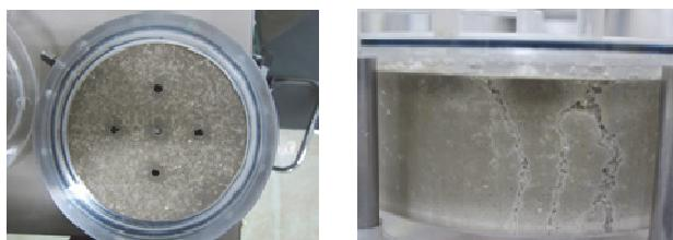
図-4 人工的な水みち作成後（左）、 $\text{CaCl}_2$ 水溶液を通水し、水みちが1本に収斂しない状況（右）
