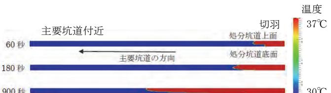
図-5 処分坑道内における火災解析結果 (温度)
