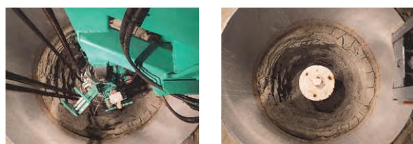
図-5 緩衝材除去試験状況
