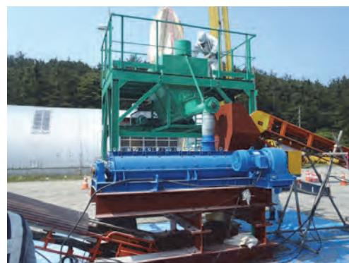
図-7 連続式二軸強制ミキサ (GeoTom10)
