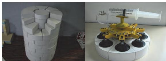
図-18 1/10 人工バリア及び把持装置模型
