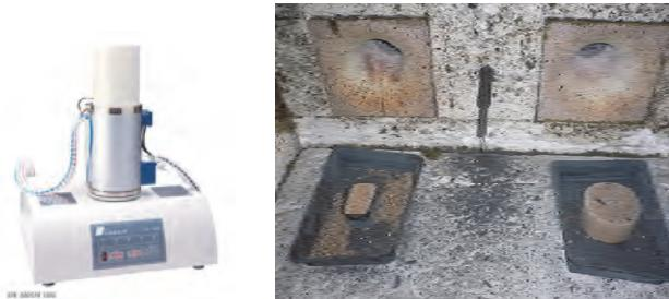
図-8 加熱装置（左）及び加熱実験炉（右）
