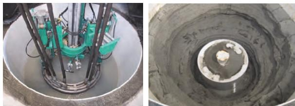
図-7 緩衝材除去試験状況（ケース1）
