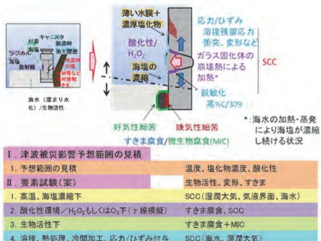
図-10 津波被害を想定した腐食損傷と今後の課題の整理（模式図）
