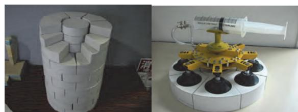
図-17 1/10 人工バリア及び把持装置模型
