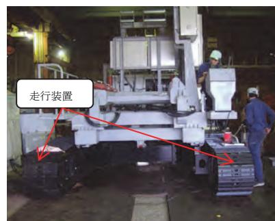
図-2 油圧ユニットと走行装置の組立状況
