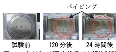
図-3 パイピング発生状況 (小規模試験)
