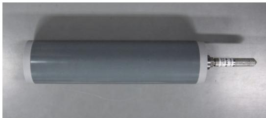
図-3 水分センサを接続した小型地中無線送信装置
