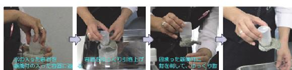
図-18 緩衝材の止水試験の方法
