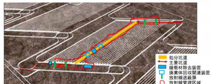
図-2 処分場のパネル例における回収作業概念の検討
