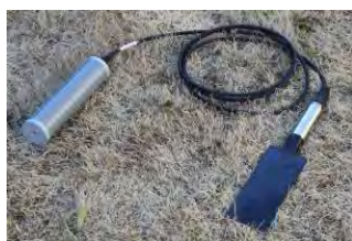
図-1 圧力センサ(右)を接続した小型地中無線送信装置(左)
