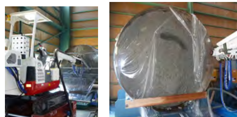
図-4 横置き方式の断面実寸法試験の様子
