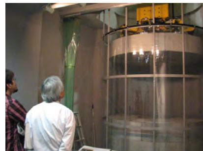
図-7 模擬緩衝材定置の動作
