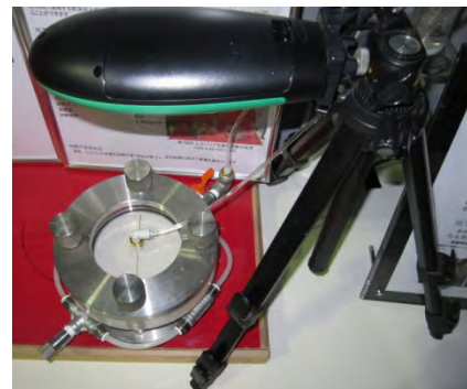
図-9 緩衝材の隙間閉塞試験状況
