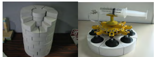
図-22 1/10 人工バリア及び把持装置模型
