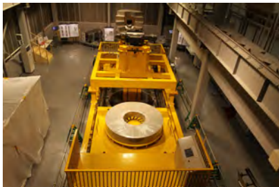
図-2 緩衝材定置試験設備の全景
