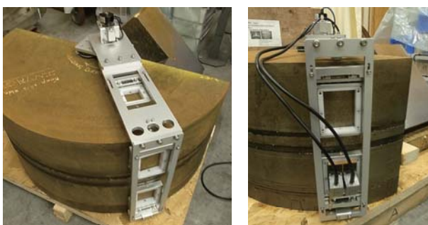
(a) オーバーパック検査用治具 (b) 非破壊検査試験状況 図-3 平蓋型オーバーパックの非破壊検査試験
