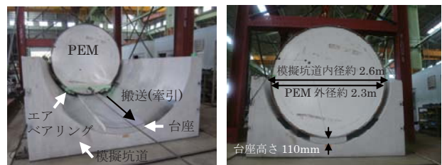
図-4 台座方式における PEM の搬送・定置試験
