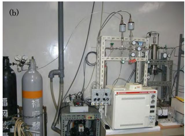
図-6 (a) 気体状水素発生量定量装置の概念図及び(b) 写真。
