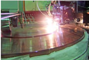
図-3 回転偏芯電極 TIG 溶接法適用性確認試験
