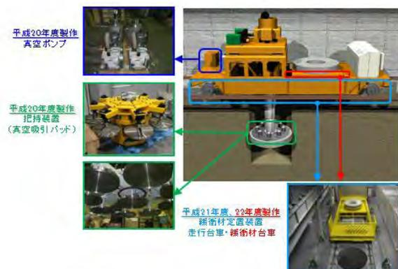
図-2 緩衝材定置試験設備の整備状況
