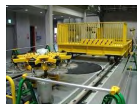
緩衝材定置試験設備
