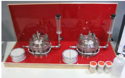
図-3 緩衝材可視化試験装置
