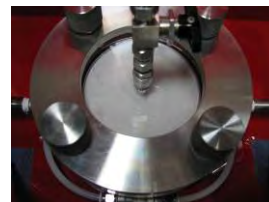
緩衝材可視化試験装置 (すき間なし)
