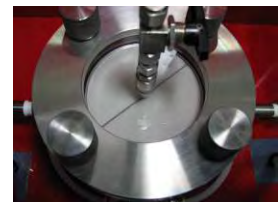
緩衝材可視化試験装置 (すき間あり)
