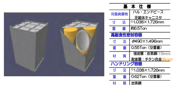
図-2 長期閉じ込め型金属容器の概念図
