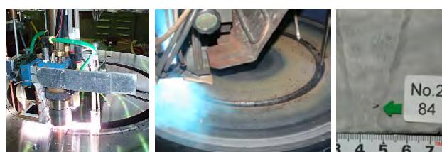
図-2 TIG, MAG 溶接状況及び自然欠陥段削り撮影例
