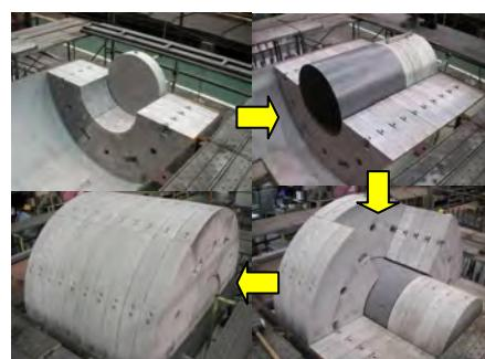
図-3 PEM 容器への人工バリア組立試験状況
