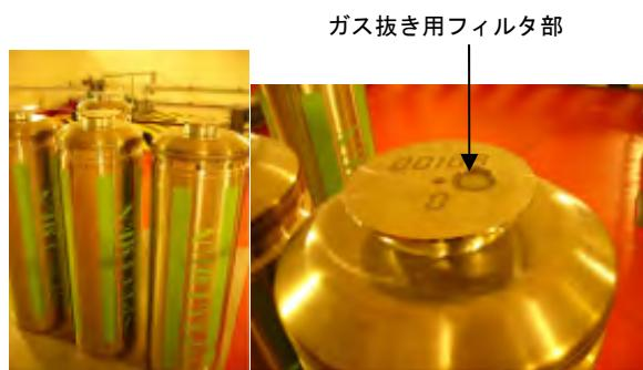
図-2 CSD-C(模擬体)の外形とガス抜き用フィルタ
