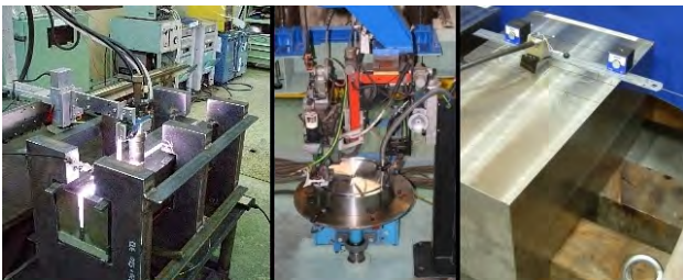
図-2 TIG, MAG 溶接及びフェイズドアレイ法試験状況
