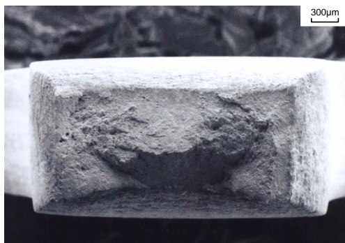
(b) 破面の SEM 写真 (SCC 破面無し)
