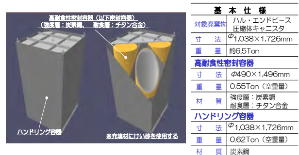
図-2 長期閉じ込め型金属容器の概念図
