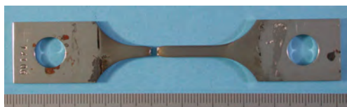
(a) 試験後の試験片外観写真
