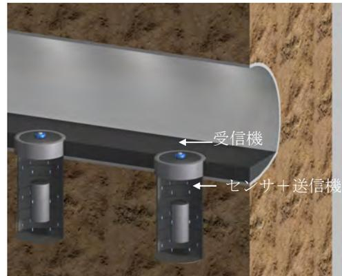
図-3 モニタリングと地中無線通信のイメージ
