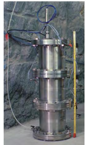
図-3 TDR 円柱供試体試験
