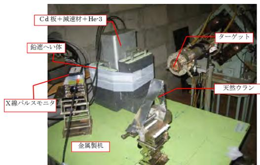
図-6 X線パルス強度モニタを用いた試験状況
