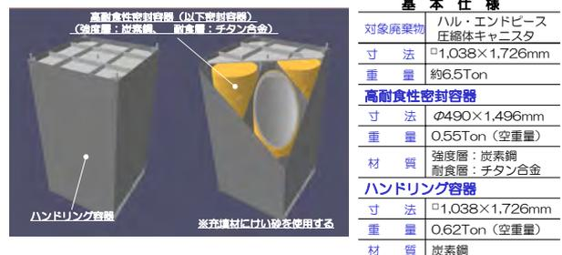
図-2 長期閉じ込め型金属容器の概念図
