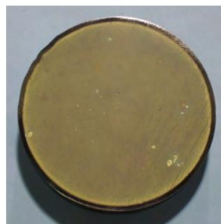
図-1 AgA 岩石固化体(800cc)の断面
