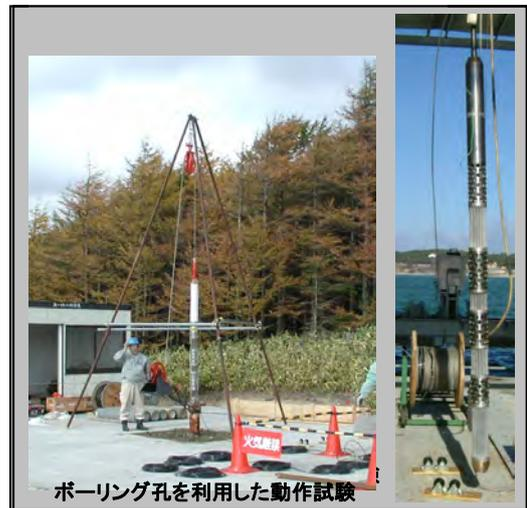
図-2 孔内震源と圧力補償ユニットの動作試験
