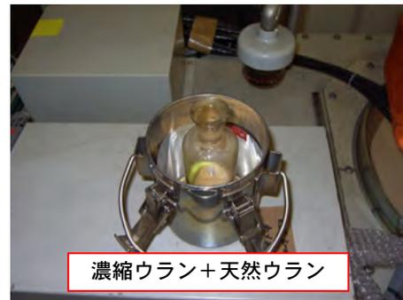
図-7 ウラン濃縮度測定試料
