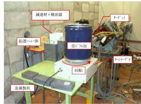
図-4 光中性子法によるウラン濃度測定装置
