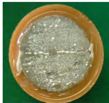
図-2 ひび割れを有するセメント系試料の閉塞状況（海水系模擬地下水に浸漬後の状況）
