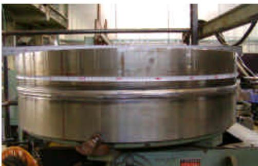
図-3 溶接試験体外観(TIG 溶接)
