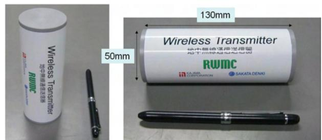
図-11 最近の技術開発の成果である小型化送信装置
