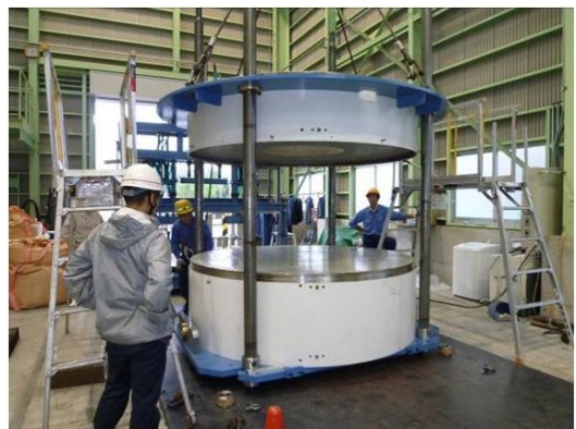
図5 鋼殻リングを利用したPEMの組立
