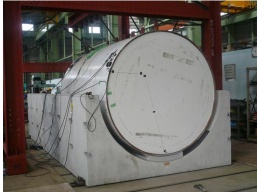
図6 台座を利用したPEMの定置
