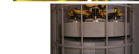
図13 真空把持装置とテレスコピックの動作状況
