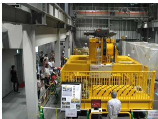
図11 緩衝材定置試験の様子・1
