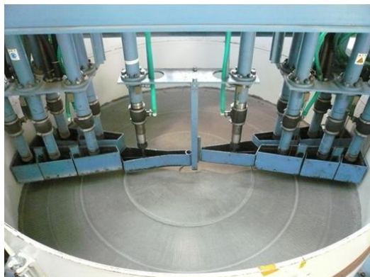
図4 鋼殻リング内での緩衝材の製作
