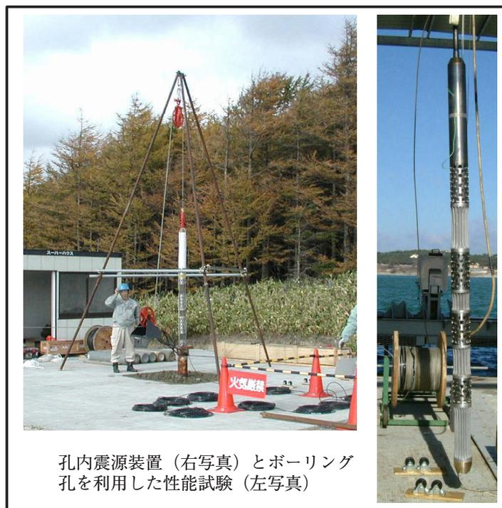
写真-1 ボーリング孔を利用した孔内震源装置試験
