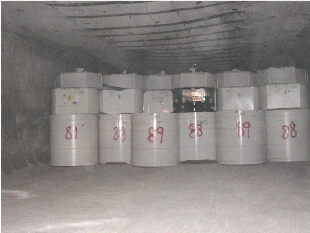
＜WIPPの廃棄体定置状況（上に載っているのはMgO入りの容器）＞
