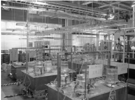
写-2 ガス発生量試験装置の全景
