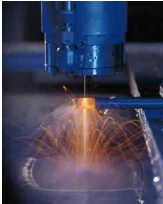
図 7-1 レーザー・ウォータージェットハイブリッド加工
